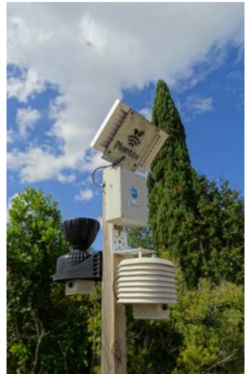
La centralina che monitora i parametri ambientali nell'impianto pilota
